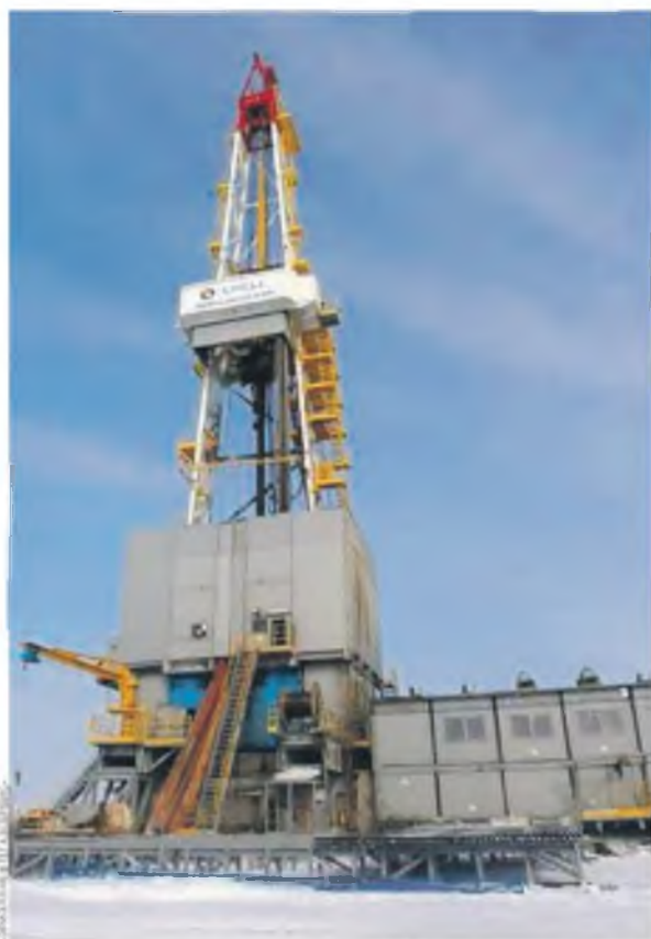
Впервые в России именно на этой серийной уралмашевской буровой установке на уренгойском месторождении специалисты компании «Эриэлл Нефтегазсервис» пробурили уже две рекордные субгоризонтальные скважины на ачимовские отложения глубиной более 5200 м с протяженностью горизонтального участка 982 м и 1019 м
